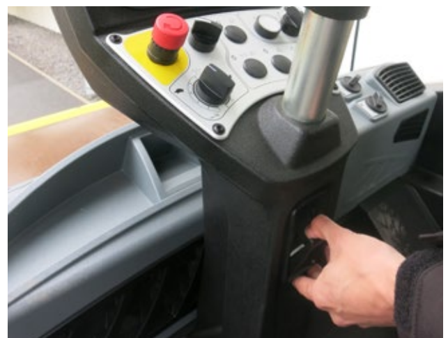
La colonne de direction : réglable en fonction des besoins du conducteur.
