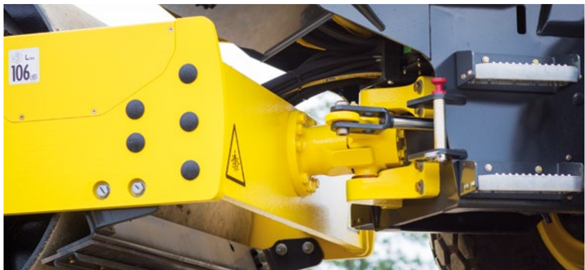
L'as de la propreté : l'articulation ne nécessite aucun entretien et la machine fonctionne sans la moindre lubrification.
