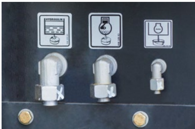
Intelligent : les consommables peuvent être facilement évacués depuis l'extérieur.
